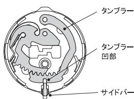
表裏互い違いに配置した14枚のタンブラーがピッキング攻撃ポイントを左右に分散させているため、タンブラー凹部が正しい位置にすべてそろわないとサイドバーが移動できず、ピッキングによる不正解錠は非常に困難です。
